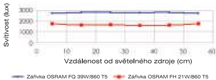
Prosvětlení panelu o rozměrech 850 x 600 mm z desky QUINN CAST Lumina o tloušťce 10 mm
