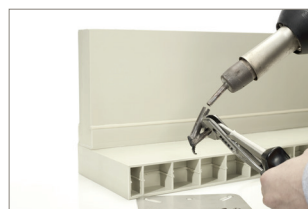
SPRÁVNÁ INSTALACE SVAŘOVACÍ HLAVY
